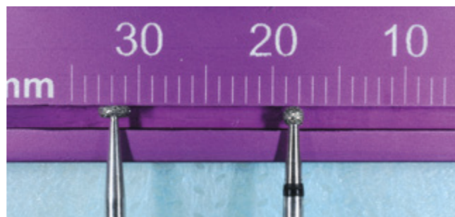
Рис. 4. Для выполнения маркировки используют различные боры, при этом глубина погружения бора зависит от размера его рабочей части.
