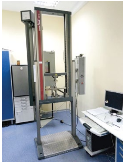
Рисунок 1. Универсальная испытательная машина Zwick Roell Z010 и персональный компьютер с программным обеспечением TestXpert.
